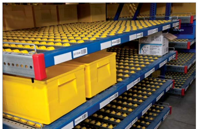
Átfutó görgősoros polcrendszer a kommisszó raktárban
